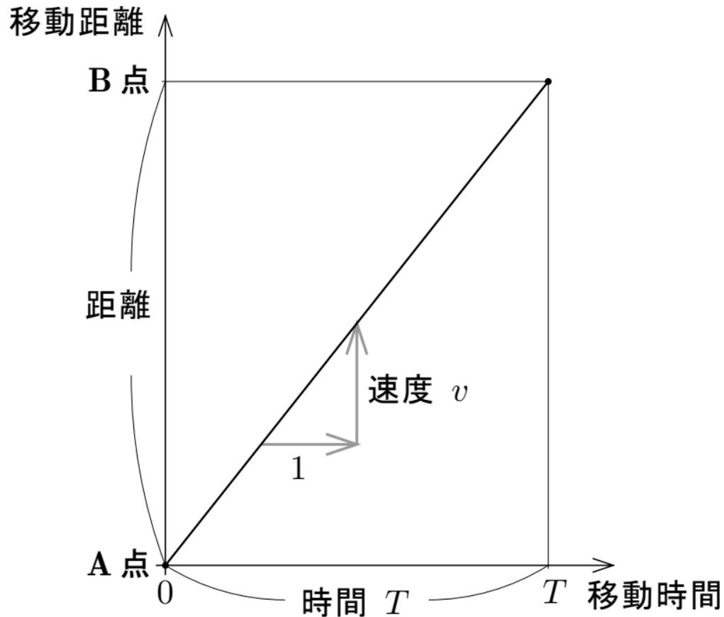
A 点から移動を始めてから一定時間  $T$  の間一定速度  $v$  で移動したとき、移動時間に対する移動距離のグラフは例えば右図のような線分であり、A 点から B 点までの移動距離は移動速度  $v$  と移動時間  $T$  との積  $vT$  である。
