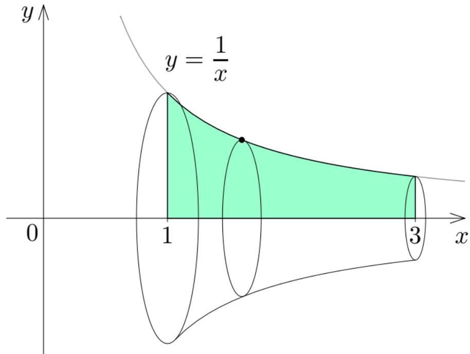
例  $xy$  座標平面において不等式  $1 \leq x \leq 3$  と  $0 \leq y \leq \frac{1}{x}$  との連立で表される平面領域を考える. 3次元空間においてこの平面領域を  $x$  軸を中心に回転させてできる回転体の体積を求める.
