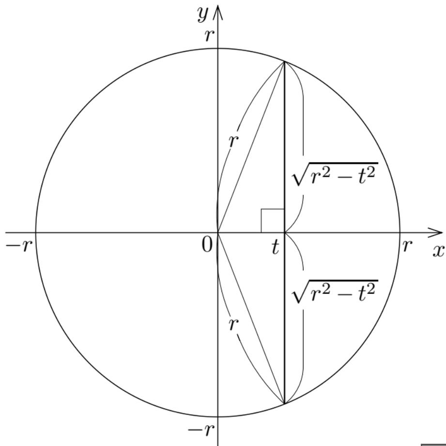
問8.3.4 立体図形  $V$  の底面は半径が  $r$  である円で囲まれる平面領域であり、底面の円のある直径に垂直な各平面と立体図形  $V$  との共通部分は底辺が  $V$  の底面の円の弦である正三角形で囲まれる平面領域である。この立体図形  $V$  の体積を求めよ。
