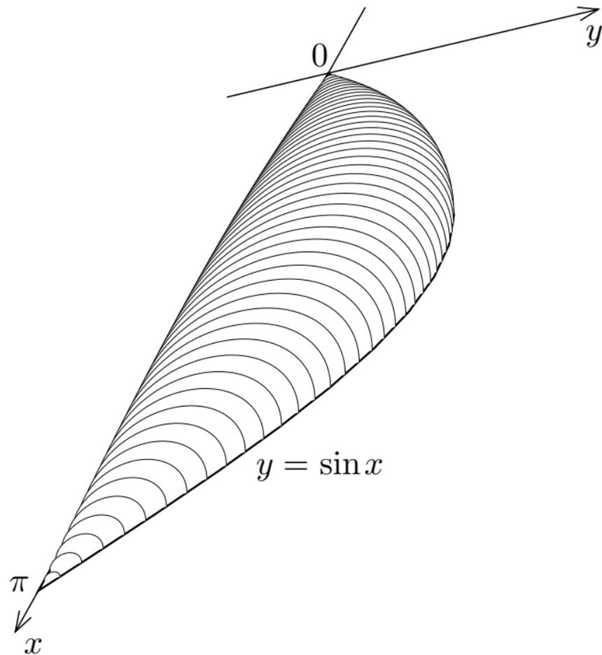
$0 \leq t \leq \pi$  である各実数  $t$  に対して、 $x$  軸の座標が  $t$  である点が属し  $x$  軸に垂直な平面と立体  $V$  との共通部分の半円の直径である線分を  $xy$  座標平面で図示すると右図のようになる。
