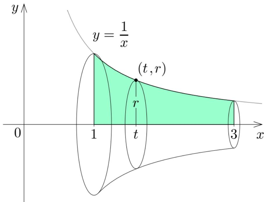
**例**  $xy$  座標平面において不等式  $1 \leq x \leq 3$  と  $0 \leq y \leq \frac{1}{x}$  との連立で表される平面領域を考える. 3次元空間においてこの平面領域を  $x$  軸を中心に回転させてできる回転体の体積を求める.
