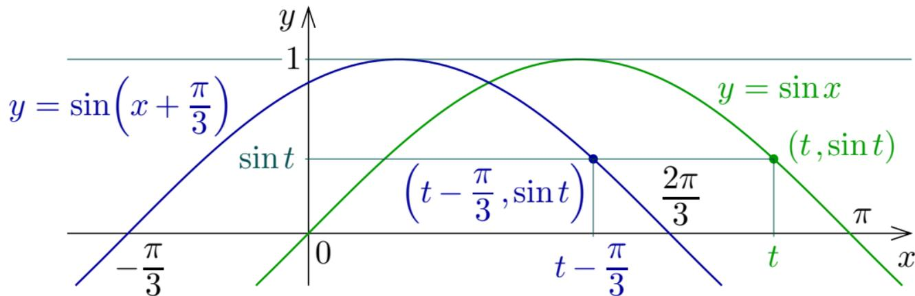
だけ平行移動させた点である. 従って, 関数  $y = \sin\left(x + \frac{\pi}{3}\right)$  のグラフは関数  $y = \sin x$  のグラフを  $x$  軸の向きに  $-\frac{\pi}{3}$  だけ平行移動させた曲線である.
