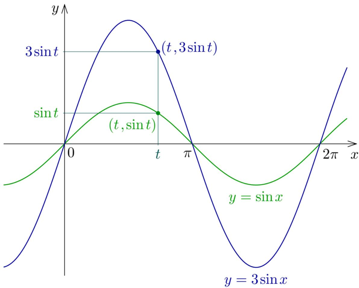
関数  $y = 3\sin x$  のグラフは関数  $y = \sin x$  のグラフの各点の  $y$  座標だけを3倍した点の全体である。つまり、 $y = 3\sin x$  のグラフは  $y = \sin x$  のグラフを  $y$  座標方向にだけ3倍した曲線である。
