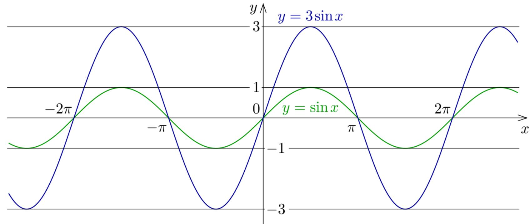
関数  $y = 3\sin x$  のグラフは関数  $y = \sin x$  のグラフの各点の  $y$  座標だけを3倍した点の全体である。つまり、 $y = 3\sin x$  のグラフは  $y = \sin x$  のグラフを  $y$  座標方向にだけ3倍した曲線である。更に  $y = -3\sin x$  のグラフは  $y = 3\sin x$  のグラフと  $x$  軸に関して対称な曲線である。
